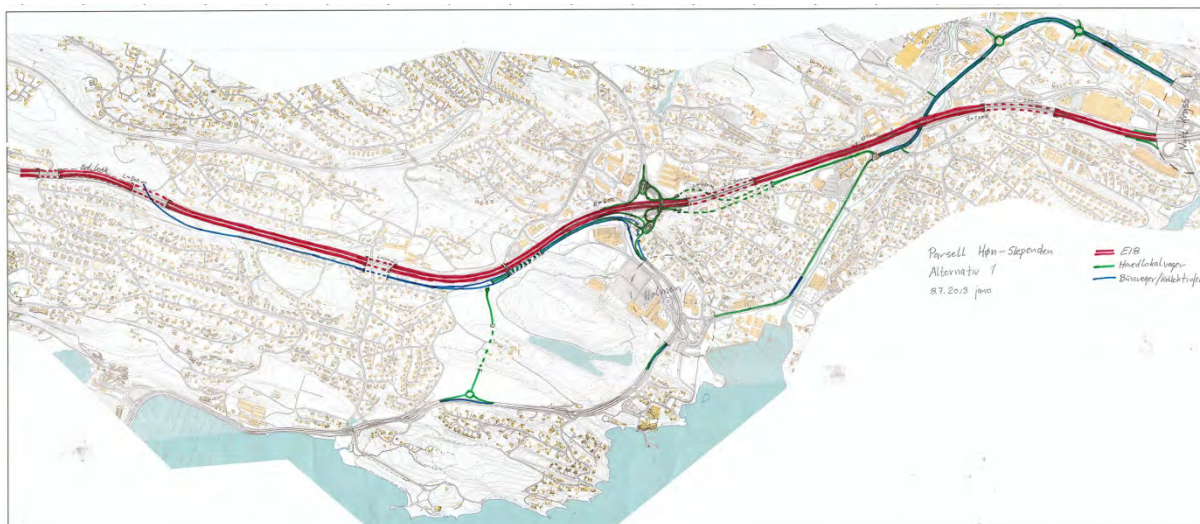
Figur 9 – Skisse av alternativ 2.1 med seksfelts E18 i dagen (rød) og parallell kollektivtrasé (blå) og lokalveg (grønn). Her vist med alt. 4.1 Syverstaddiagonalen fra parsell 4. Utforming av kryss, miljøløkk og lokalvegssystem skal vurderes videre
