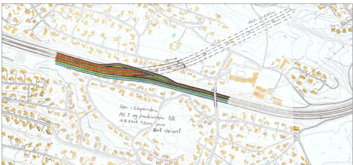
Figur 4-17: Skrå tunnelmunning med kort tunnelportal før fjellpåkugg
