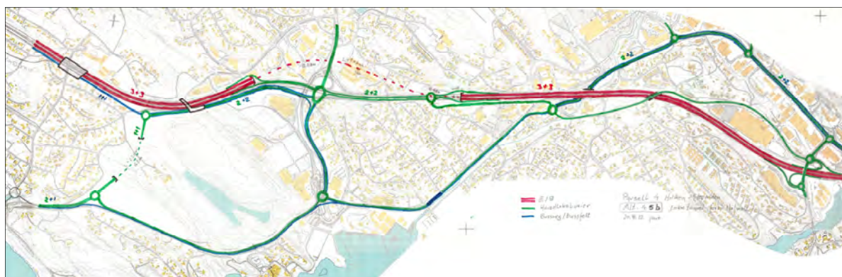
Figur 4-11: Skisse av mulig konsept for tunnel forbi Holmenkrysset.
