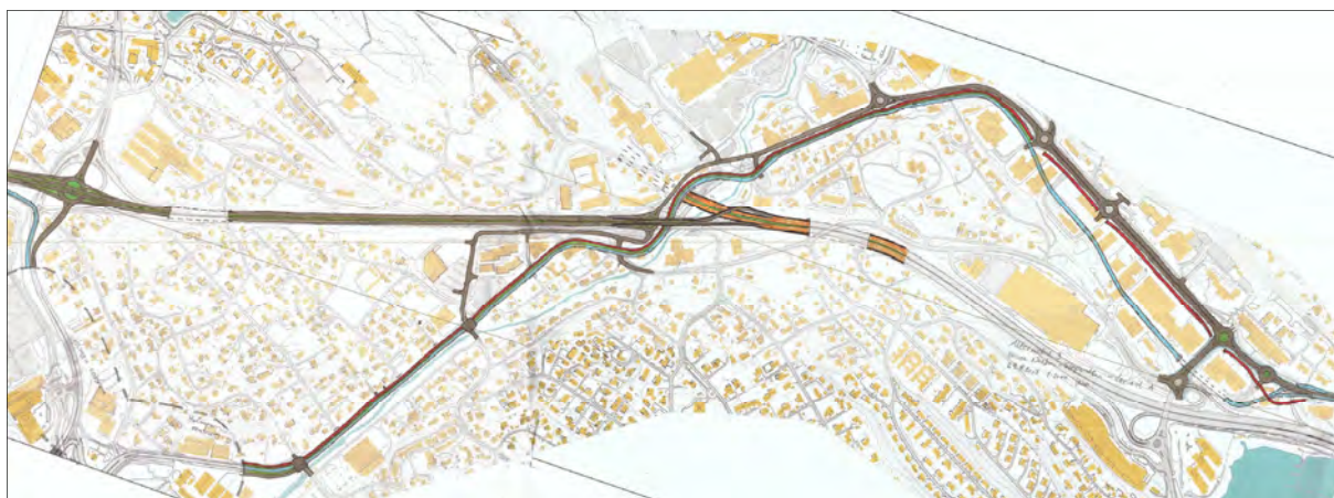
Figur 4-19: Hovedsamleveg og lokalvegsystem i alt. G med lang tunnel for E18. For kollektivtrafikk utredes også løsning langs E18
