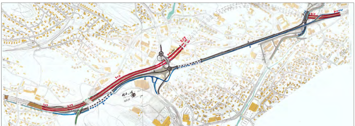
Figur 4-9: Skisse av mulig konsept for tunnel Holmen-Neselva, variant 3 med påhugg Ravnsborg og påkobling av østvendte ramper vest for Holmen
