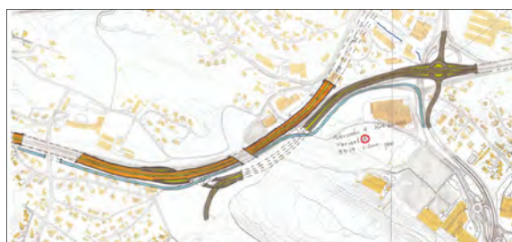
Figur 5-3: Kobling med hovedsamleveg, E18 i kort tunnel
