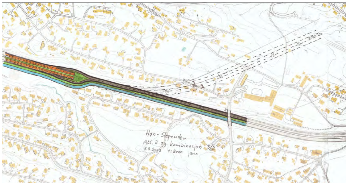
Figur 4-18: Rett tunnelmunning med lang tunnelportal/betongtunnel før fjellpåkugg
