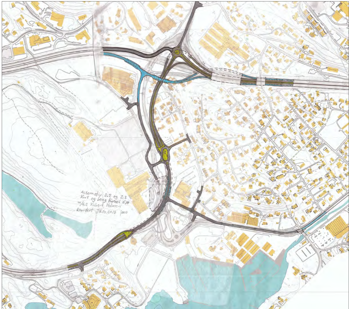
Figur 5-5: Alternativ 4.2 med kulvert gjennom Holmen sentrum, vist sammen med alternativ A med E18 i dagen
